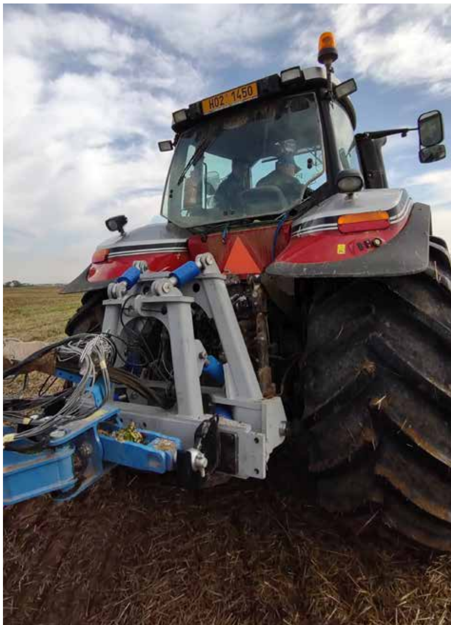
Měřicí zařízení tahových a tlakových sil na tříbodovém závěsu mobilního prostředku. Zemědělské družstvo Rosovice. Radek Pražan, 2022.
