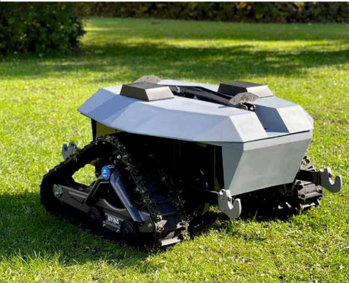
Autonomní robotický nosič nářadí z prototypové laboratoře Prolab Technické fakulty České zemědělské univerzity v Praze. Petr Hnízdil, 2023.
