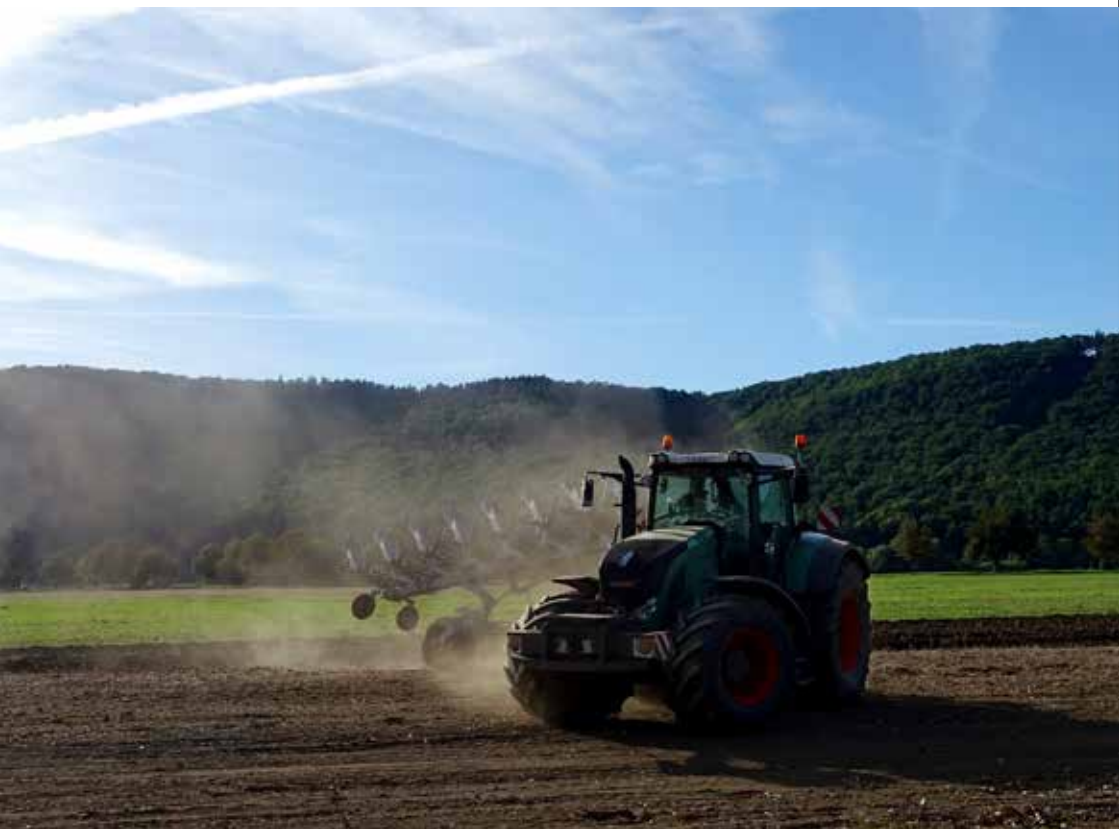
Orba na poli v nivě Berounky v katastru obce Radotín (Praha). Orební souprava traktoru Fendt a osmi radličného návěsného obracecího pluhu. Radim Vácha, 2016.
