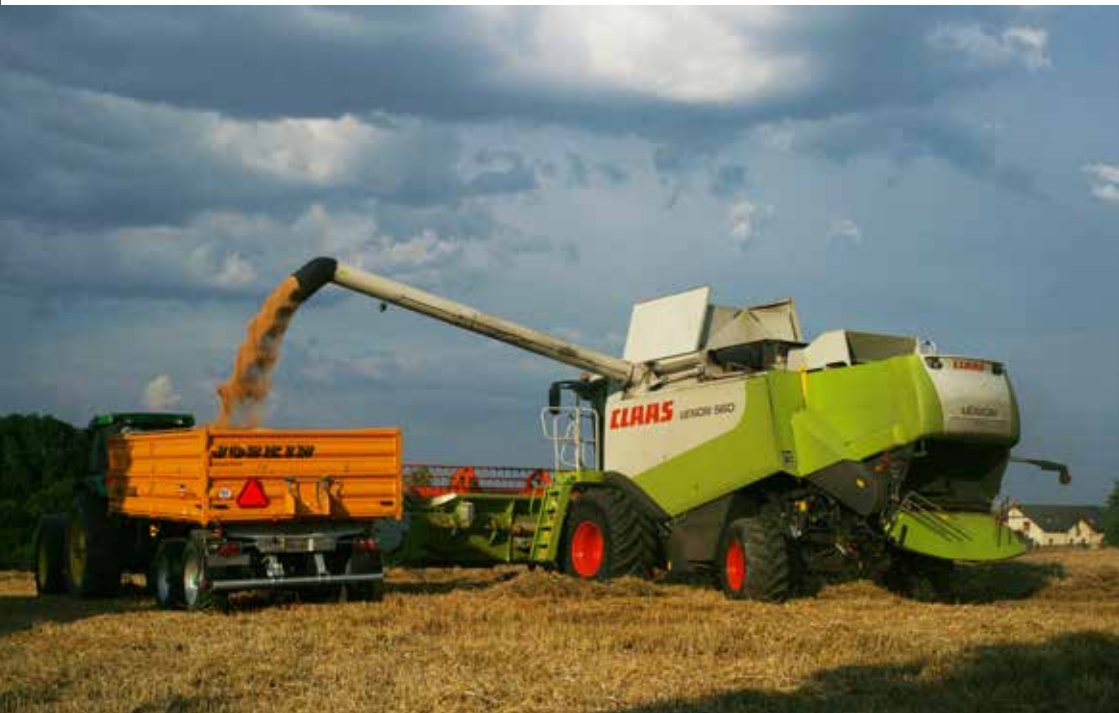
Podzimní sklizeň obilovin v katastru obce Cholupice (Praha). Sklízecí mlátička Claas Lexion 560 a odvozní souprava traktoru John Deere a návěsu Joskin. Radim Vácha, 2014.
