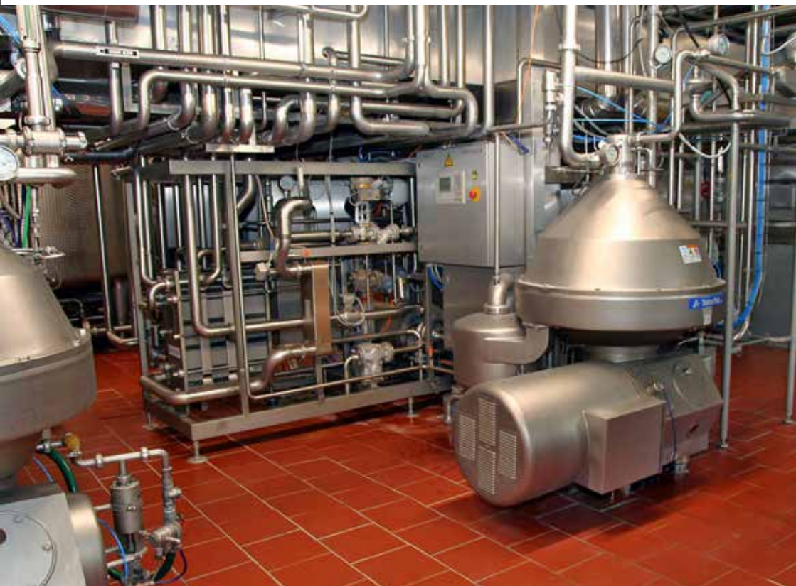
Ukázka technologie využívané při ošetřování mléka. Pasterační stanice Mlékárny Hlinsko. Archiv Agral s. r. o., 2021.
