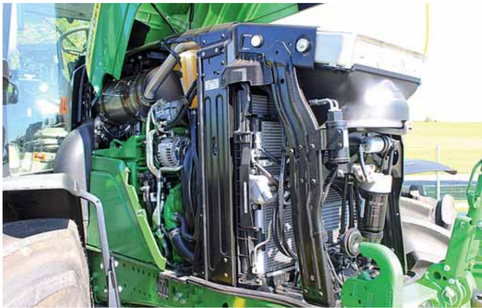
Sestřelivý motor PVS o objemu 6,8 l disponuje navýšováním IPM. U traktoru John Deere 6M 200 má maximální výkon včetně navýšení 168 kW/229 k
