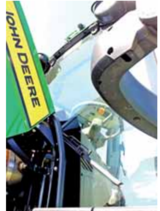
Přibližně čelní sklo od podlahy až po střechní okno zlepšuje výhled z kabiny. Štěrka čelního okna má velkou plochu stírání, kterou si lze omezit tím, že se zvolí vyšší rychlost pohybu
