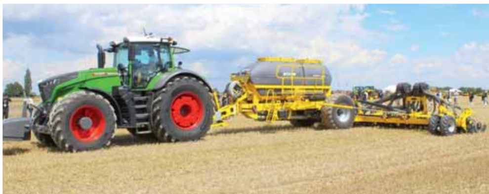
Nový secí stroj pro přímé setí Directo NE 12 000 se záběrem dvanácti metrů a novou koncepcí byl představen na akci Bednar Camp 2025 Foto Petr Beneš
