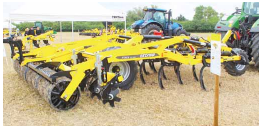
Radličkový kypřič Fenix FO 5003 druhé generace je univerzálně využitelný pro mělké i hluboké zpracování půdy do hloubky až 35 cm Foto Petr Beneš
