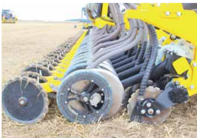
Patentované jednokotočové secí botky stroje Directo NE 12 000 ukládají osivo v celém pracovním záběru do shodné hloubky (minimálně dvou centimetrů). Přitlačné kolečko zaručuje kontakt osiva s půdou. Pod osivo a mírně stranou výsevní rýhy je ukládáno hnojivo Foto Petr Beneš
