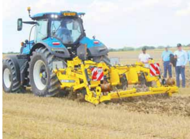
Úkolem stroje Terraduo DN 3000 HM7R je rozlámat ztuhlé půdní desky v půdě a na povrchu co nejméně misit ornicí a organické zbytky Foto Petr Beneš
