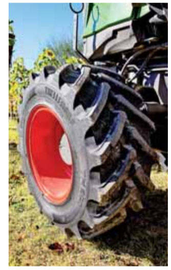
Pneumatika TM200 ProgressiveTraction® je první VF pneumatika vyvinutá speciálně pro traktory pracující v meziřadkových kulturách
