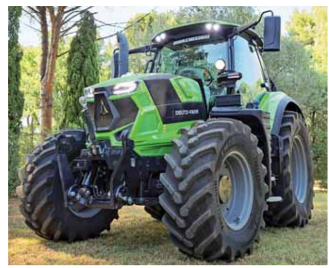
Osvědčená pneumatika TM800 PowerFlex spojuje VF konstrukci s patentovaným vzorem ProgressiveTraction® pro vyšší trakci a nižší zhuštění půdy
