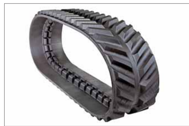
ART1000 je nový pásový systém pro vysoce výkonné stroje, který vyniká vysokou trakční silou, samočisticí schopností a ochranou půdy i při intenzivním nasazení
